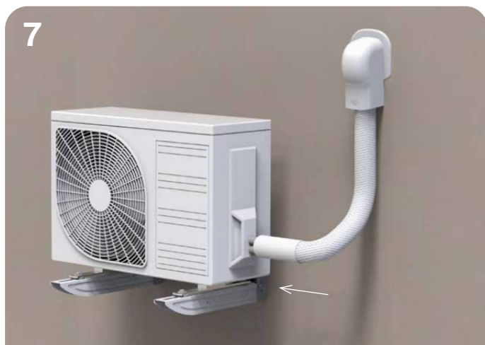
7 Cartellare le tubazioni frigorifere e fissarle ai rubinetti dell'unità esterna, collegare l'alimentazione. Avvicinare e posizionare il raccordo in gomma in prossimità dei rubinetti
